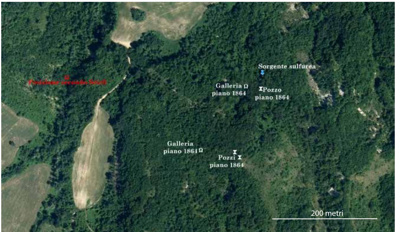
Fig. 6 – Georeferenziazione dei punti notevoli del piano planimetrico 1864 e delle coordinate di Scilli 1995 (ortofoto Regione Emilia-Romagna).
