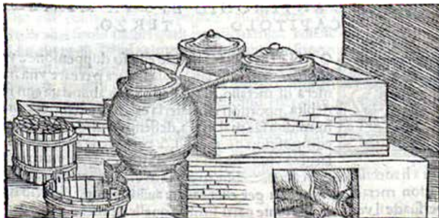
Fig. 2 – Distillazione dello zolfo in un'incisione da un'edizione successiva della Pirotechnia di Biringuccio (BIRINGUCCIO 1559). Rispetto alla raffigurazione della I edizione dell'opera, la qualità è inferiore e la prospettiva resa specularmente, probabilmente in seguito alla realizzazione di una nuova matrice intagliata ricopiando "in positivo" l'illustrazione dell'edizione originale.
