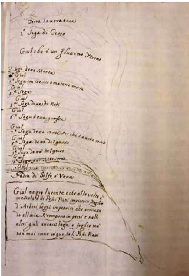
Fig. 12 – BUB, Fondo Marsili, ms 88, E, 3, c. 3, Profilo d'uno de Pozzi da Solfo di Casalbuono . Sezione geologica di Luigi Ferdinando Marsili, databile al 1717-1718 circa, ricavata dallo studio di un pozzo minerario della solfatara di Casalbuono (Cesena): essa riporta analiticamente i nomi propri del gergo minerario locale per gli strati e gli interstrati della successione evaporitica. Tale materiale era già previsto ad illustrazione di un primo manoscritto marsiliano sullo stesso tema, intitolato Osservazioni fatte nelle Miniere del Gesso e Solfo esistenti nel Principato di Meldola, sotto il dì delli 22 Settembre 1717 (BUB, Fondo Marsili, ms 88, E, 6). Ad esso si fa poi riferimento anche nella di poco successiva Storia Naturale .
