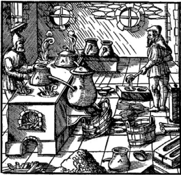
Fig. 5 – Distillazione dello zolfo in un'incisione da una versione italiana del De Re Metallica di Agricola, intitolata De l'arte de metalli (AGRICOLA 1563). La raffigurazione appare debitrice nei confronti delle illustrazioni dell'opera di Biringuccio, specie di quelle allegate ad edizioni successive alla prima (vedi fig. 4).
