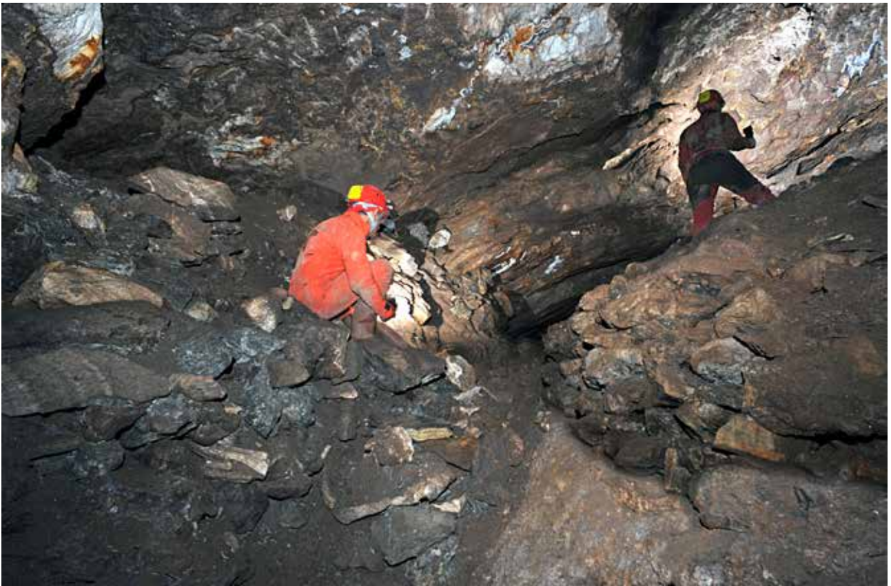
Fig. 18 – Muri di ripiena nel secondo vuoto di coltivazione (foto G. Belvederi).
