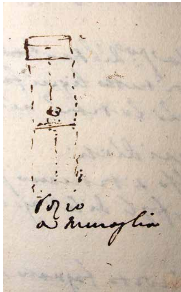
Fig. 20 – BUB, Fondo Marsili, ms 88, E, 3, c. 11r. Sezione di un pozzo di una miniera di zolfo, indicato come «pozzo a muraglia», ovvero foderato da opere in muratura.
