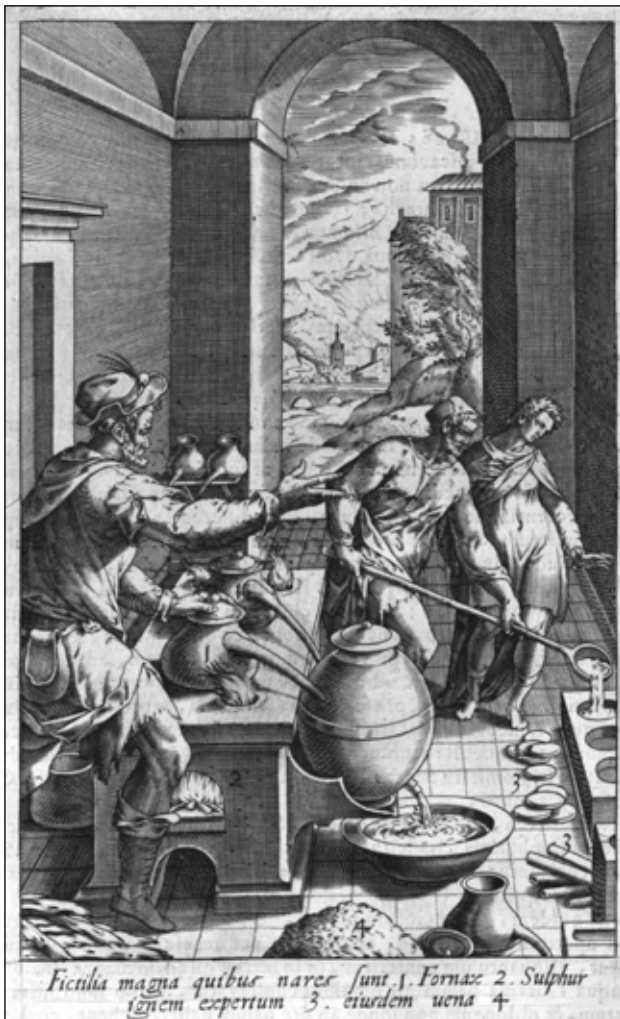
Fig. 7 – La distillazione dello zolfo in un'incisione a corredo della Metallotheca. Opus Posthumum di Michele Mercati (MERCATI 1717). La raffigurazione appare direttamente derivata da quella del De Re Metallica di Agricola (vedi supra , fig. 5). Le poche differenze vanno rintracciate in una maggiore pulizia del disegno e nel paesaggio sullo sfondo, relativo ad un opificio con comignolo da cui esce fumo (un ulteriore impianto di raffinazione dello zolfo?).
