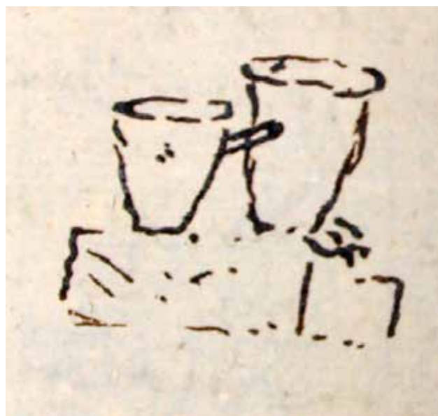
Fig. 21 – BUB, Fondo Marsili, ms 88, E, 3, c. 11v. Schizzo relativo a “pignatte” per la distillazione dello zolfo, più definito rispetto a fig. 13.
